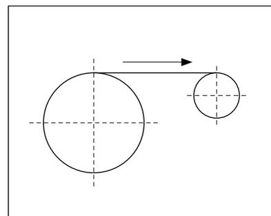
Die Trommel sollte beim Verlegen stets waagrecht, evtl. auf einen Abrollbock gelegt werden, um mechanische Beanspruchung zu vermeiden.
