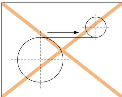
Kabel und Leitungen niemals entgegen ihrer ursprünglichen Laufrichtung von einer Trommel abnehmen.
