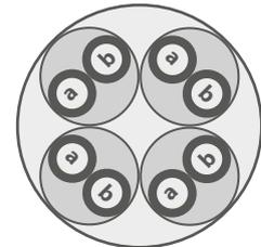
Zur Unterscheidung der einzelnen Bündel müssen die Adern wischfest mit farbigen Ringen oder die Bündel mit einer Wendel aus Kunststoffband mit aufgedruckter Bündelnummer gekennzeichnet sein.
