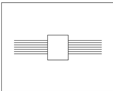
Das Bündel sollte immer gestreckt liegen, um bei der Verlegung ein eventuelles Verkleben zu vermeiden. Werden z.B. in Trassen mehrere Kabel parallel geführt, empfiehlt es sich, diese mittels Kabelbinder oder Isolierband zu bündeln.
