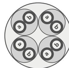
Zur Unterscheidung der einzelnen Bündel müssen die Adern wischfest mit farbigen Ringen oder die Bündel mit einer Wendel aus Kunststoffband mit aufgedruckter Bündelnummer gekennzeichnet sein.
