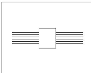
Das Bündel sollte immer gestreckt liegen, um bei der Verlegung ein eventuelles Verklemmen zu vermeiden. Werden z.B. in Trassen mehrere Kabel parallel geführt, empfiehlt es sich, diese mittels Kabelbinder oder Isolierband zu bündeln.
