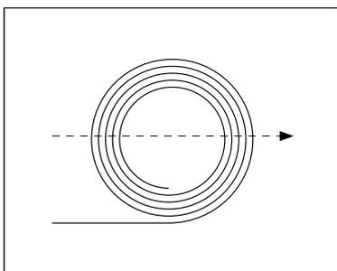
Um bei Kabelringen einen Umlenkeffekt zu vermeiden, sollten diese stets senkrecht gestellt und auf dem Boden abgerollt werden. Lässt sich aus Platzgründen das Kabel nicht in der erforderlichen Länge abrollen, so muss beim Zurückführen eine ausreichend große Biegung eingehalten werden.
